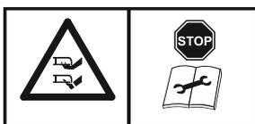
Scharfe Schneidmesser! Nicht untergreifen oder -treten. Das Produkt kann eine Gefahr darstellen, wenn es unsachgemäß betrieben wird. Lesen Sie die Bedienungsanleitung vor dem Betrieb aufmerksam durch.
