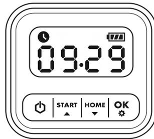
5. Das Uhr-Icon 🕒 blinkt erneut. Auf dem Display wird die Uhrzeit angezeigt. Der erste Wert stellt die Stunde dar, der zweite Wert die Minuten. Wenn ein Wert blinkt, können Sie diesen ändern. Stellen Sie zunächst die Stunde, dann die Minuten nach derselben Methode ein. Bestätigen Sie Ihre Eingabe jeweils durch Drücken der OK-Taste.
